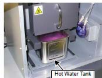
Tanque de Água Quente
