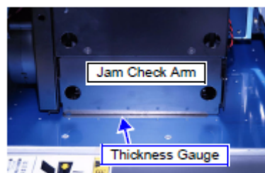
Medidor de Espessura
